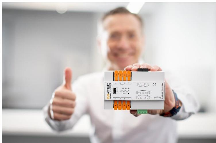
**Bildunterschrift:** Mit dem dreiphasigen Direktzähler inklusive Energiemanagementsoftware für bis zu 65 Ampere kann man seinen Energieverbrauch in Echtzeit überwachen und optimieren.
